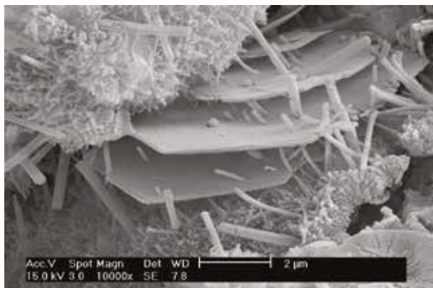
Гидратация вяжущего на основе портланд цемента в традиционных растворах для заполнения швов
