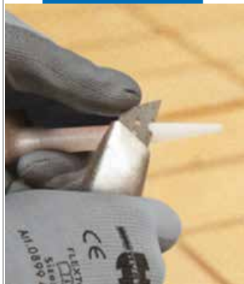
Отрезание носика в соответствии с размером швов
